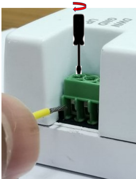
圖 8 - 使用螺絲起子順時針方向夾緊導線
