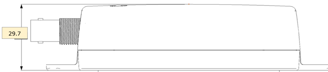
圖 7 - Modbus pH Sensor Adapter 尺寸 - 側視圖
